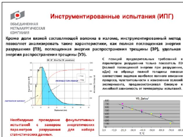
Рисунок 6 – Определение новых критериев испытаний образцов ИПГ
