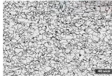
Термомеханическая прокатка + Nb создают однородную мелкодисперсную структуру
