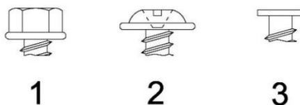
1 – стандартная шестигранная головка; 2 – круглая полусферическая головка; 3 – специальная (граненая) головка
