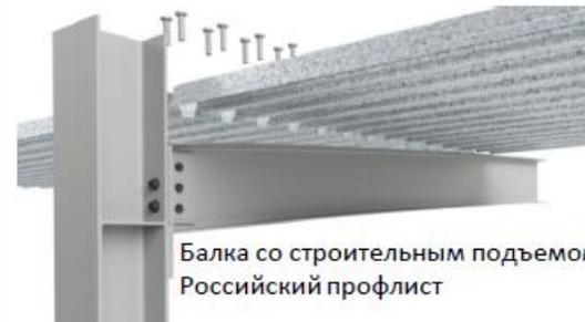
Балка со строительным подъемом
