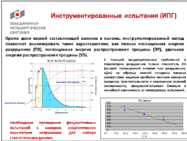
Рисунок 6 – Определение новых критериев испытаний образцов ИПГ
