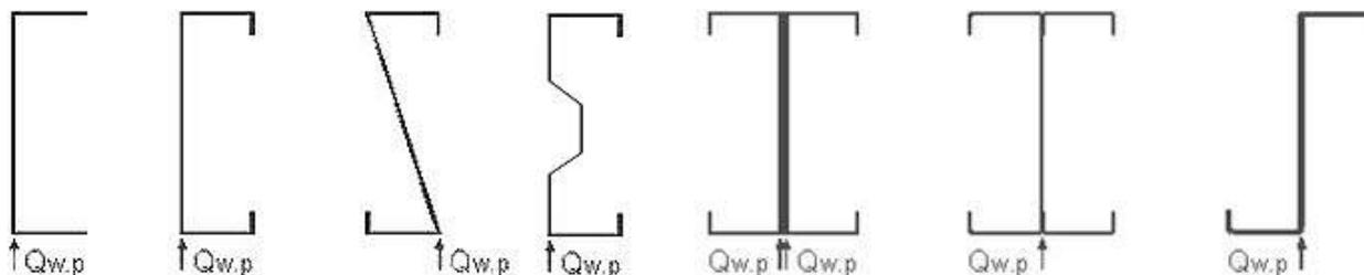
Рисунок 7.22 – Примеры сечений профилей с одной стенкой
