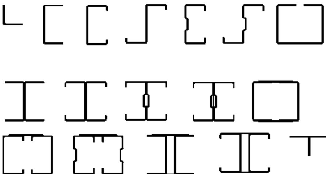
Рисунок 5.1 – Распространенные формы несущих профилей и составных сечений элементов конструкций из стальных тонкостенных холодногнутого профиля
