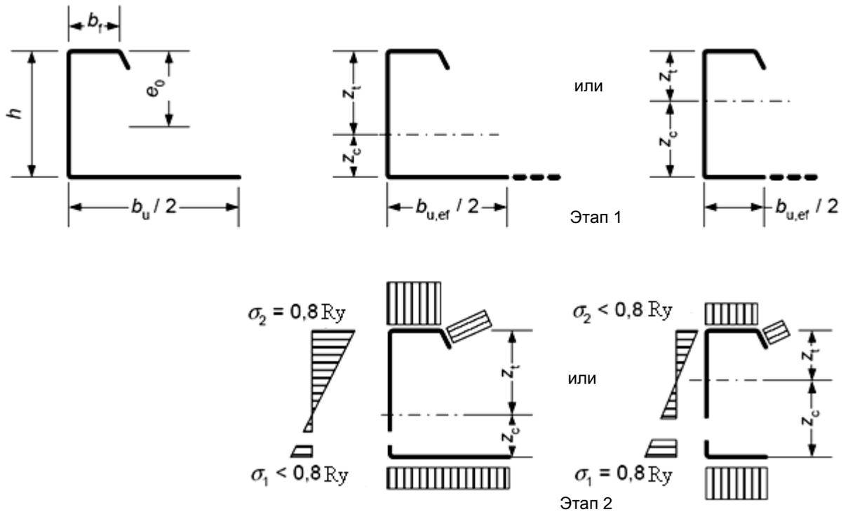
Рисунок 8.2 – Определение предельного момента при сжатой широкой полке
