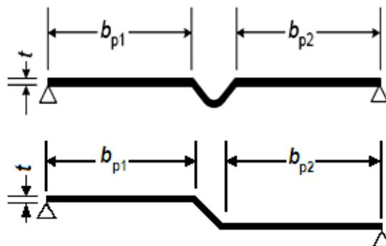
Рисунок В.7 – Схема полного сечения полки (стенки)
