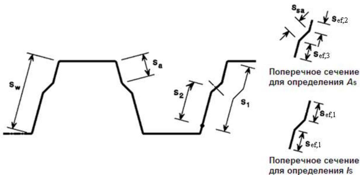
Рисунок 7.14 – Элементы жесткости стенок для трапециевидных гофрированных листов
