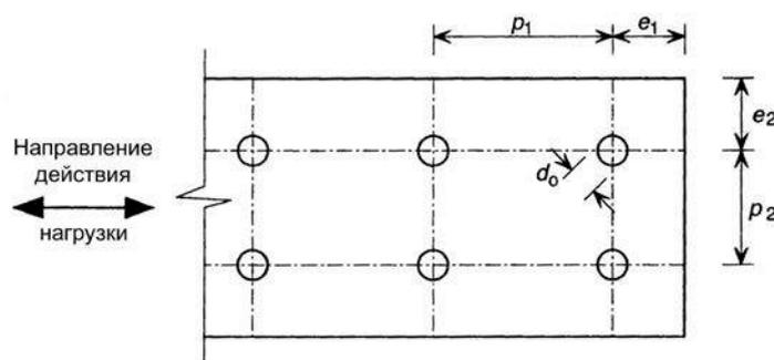
Рисунок 10.2 – Расположение точек крепежа в соединениях
