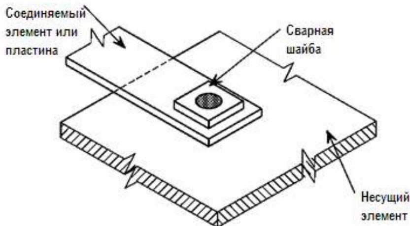
Рисунок 10.4 – Дуговая точечная сварка со сварной шайбой
