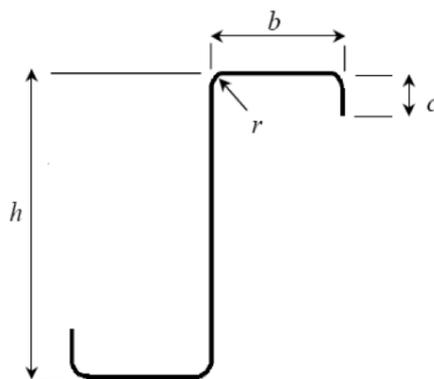
Рисунок 7.1 – Пример обозначения размеров Z-образного сечения
