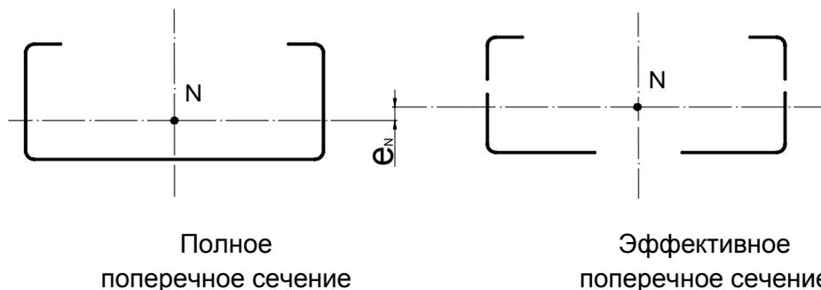
Рисунок 7.16 – Эффективное поперечное сечение при сжатии
