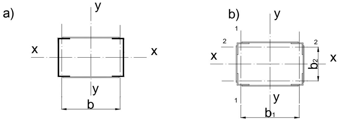
Рисунок 7.21 Стержни сквозного сечения, объединённые планками и решёткой
