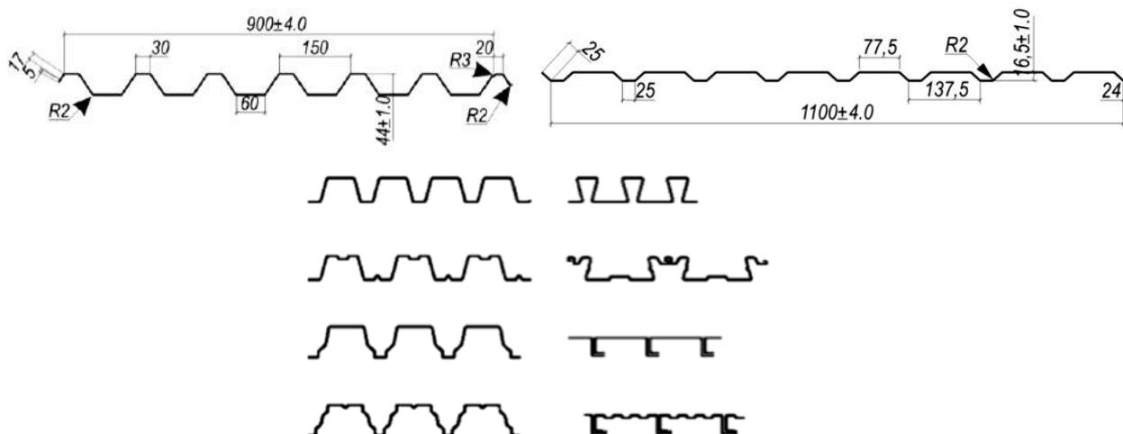
Рисунок 5.2 – Формы сечений профилированных листов и кассетных профилей
