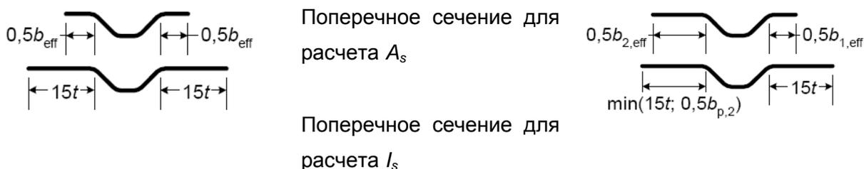
Рисунок 7.10 – Включение в ребро жесткости примыкающих участков полки
