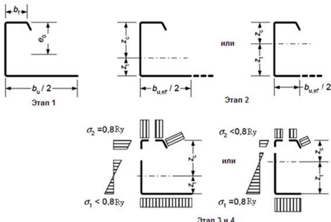
Рисунок 8.3 – Определение предельного момента при растянутой широкой полке
