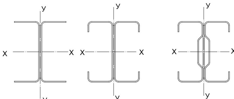
Рисунок 7.20 – Сечения сплошных стержней колонн и стоек
