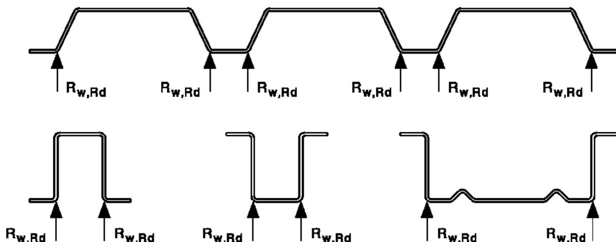
Рисунок 7.23 – Примеры профилей с двумя и более стенками.
