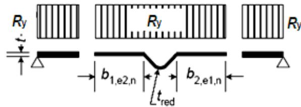
Рисунок В.12 – Окончательное расчетное сечение полки
