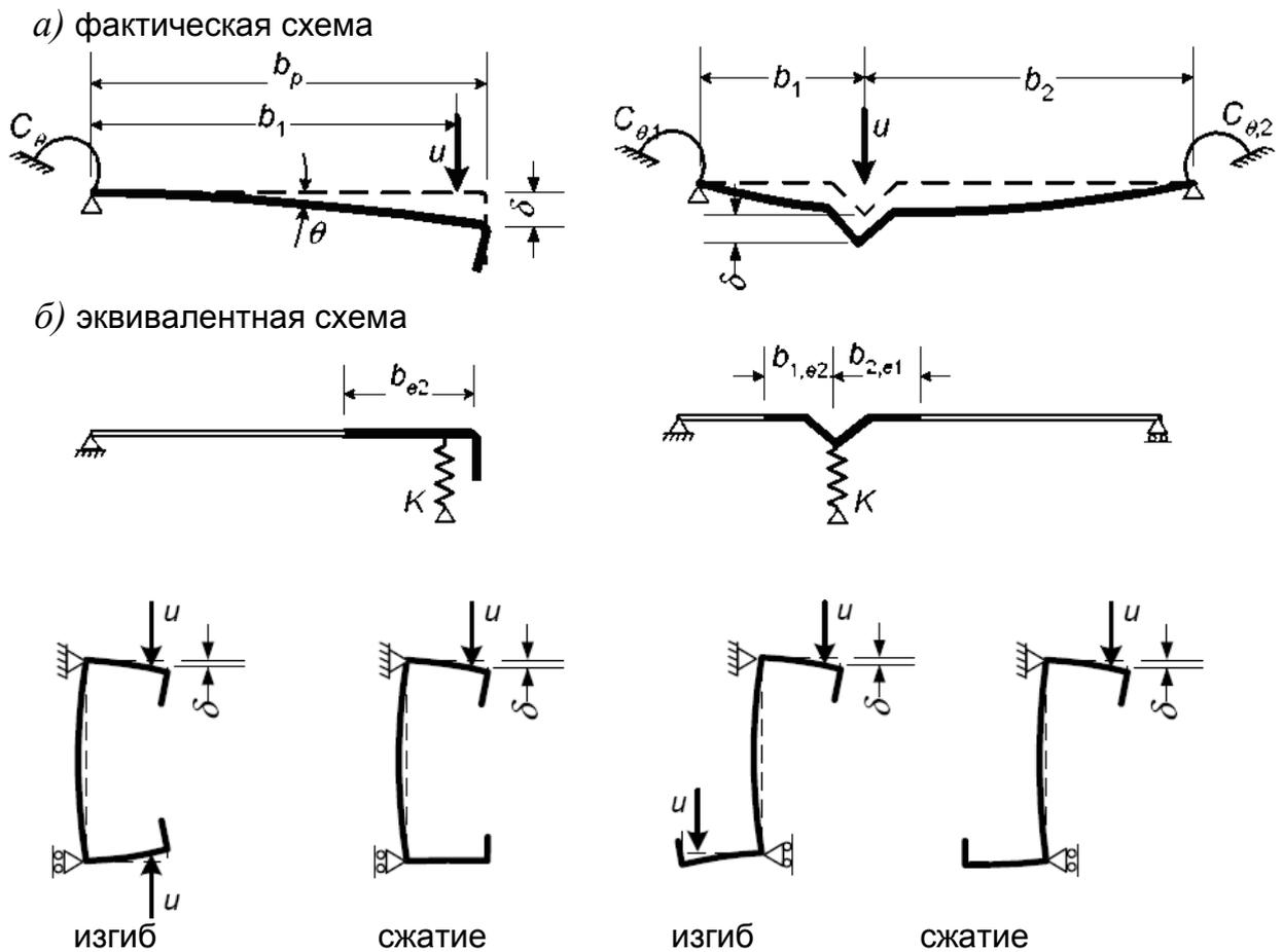
Рисунок 7.7 – Схемы к определению жесткости связей
