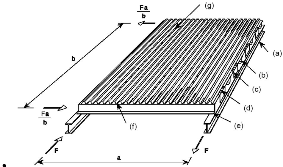
(a) – балка; (b) – прогон; (c) – связь сдвига; (d) – крепление настила к связи сдвига; (e) – прогон; (f) – крепление настила к прогону; (g) – крепление листов настила между собой
