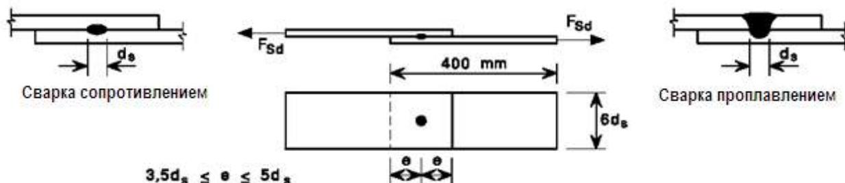
Рисунок 10.3 – Образцы для испытаний на срез сварных точек
