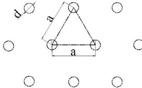
Рисунок 7.24 – Схема расположения отверстий в перфорированном профиле
