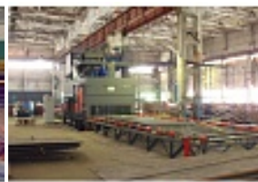
Дробеструйная очистка металлопроката
